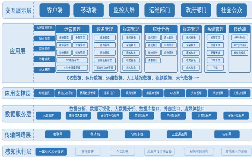
图 7.4-1 再生水智慧化平台技术路线
