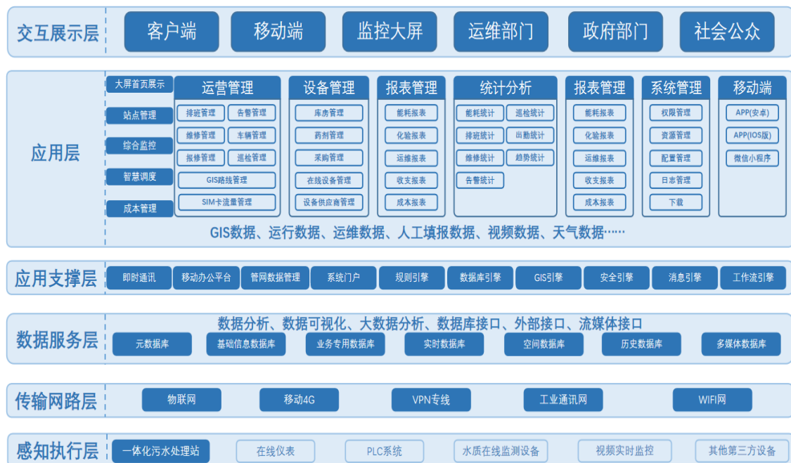
图 8.6-1 再生水智慧化平台技术路线
